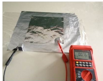
FIGURE 2 – (a) Différents modèles de condensateurs. (b) Condensateur artisanal (exp. de cours) : film plastique entre deux feuilles d'alu. (c) Modèle du condensateur plan.
