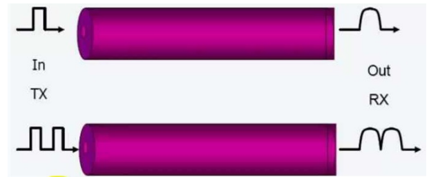
FIGURE 2 – Lors de la propagation dans une fibre optique, les impulsions lumineuses s'étalent et risquent de se superposer. Source : https://youtu.be/PWaNmJimtP0 .
