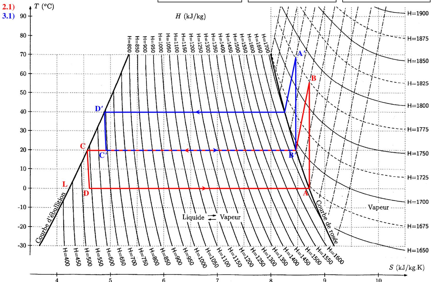
À la sortie du compresseur, on lit  $\boxed{T_b = 56^\circ\text{C}}$ .
