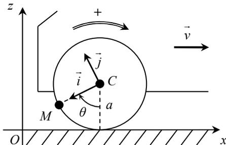
a) La roue roulant sans glisser sur la route, de quelle distance  $dx$  avance la voiture sur le sol lorsque la roue tourne d'un angle  $d\theta$ ? En déduire la relation entre  $v$  et  $\dot{\theta}$ .
