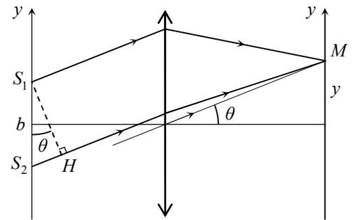
Si on revient maintenant au sens réel des rayons,  $(S_1M) = (HM)$ , donc  $\delta_{2/1} = (S_2M) - (S_1M) = (S_2H) + (HM) - (S_1M) = (S_2H)$  soit
