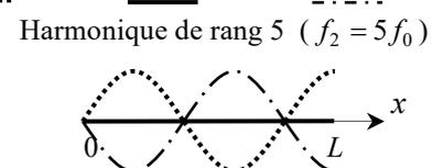
L'extrémité  $x = 0$  est un nœud de déplacement, l'extrémité  $x = L$  est un ventre de déplacement.
