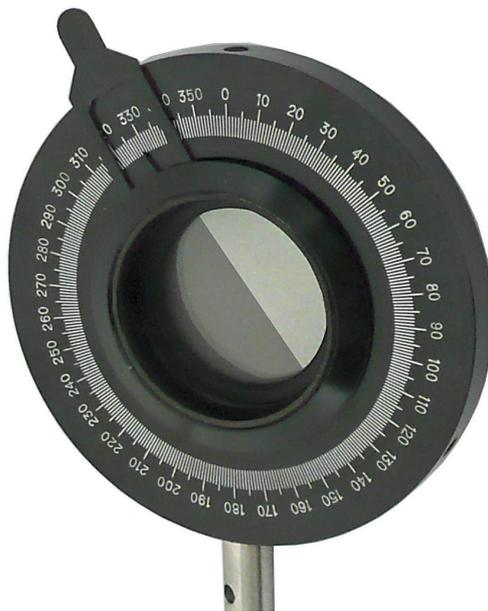
*Un analyseur à pénombre utilisé en TP : il ressemble à un polariseur, mais on distingue la séparation en deux demi-disques.*
