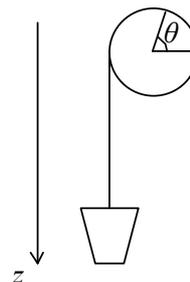
Le système étant laissé libre, déterminer l'accélération du seau en appliquant le théorème du moment cinétique au système complet (cylindre, chaîne, seau).
