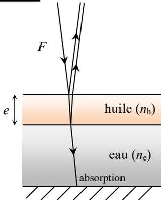
On a représenté les rayons avec une légère incidence pour la lisibilité, mais on supposera cet angle d'incidence nul dans la suite. Les deux rayons qui interfèrent sont le rayon réfléchi à l'interface air/huile et le rayon réfléchi à l'interface huile/eau.
