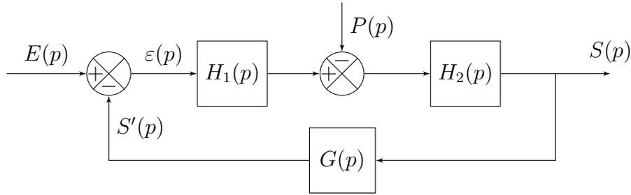
FIGURE 19 – Schéma-blocs générique d'un système asservi.
