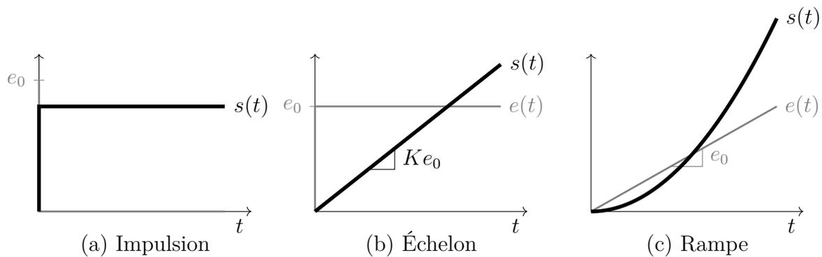
FIGURE 1 – Réponses temporelles d'un système intégrateur.
