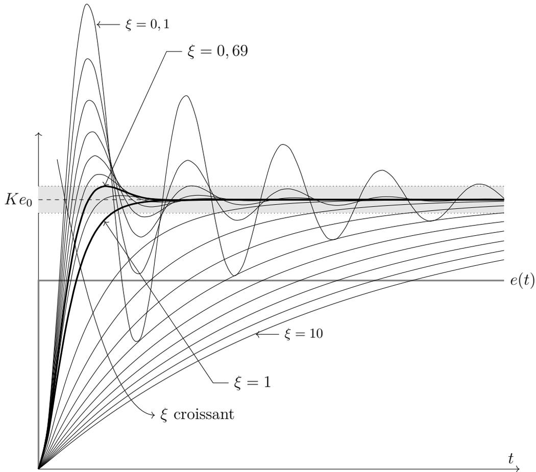
FIGURE 16 – Réponse indicielle d'un système du second ordre en fonction du facteur d'amortissement. Les courbes en gras représentent les réponses les plus rapides sans ( $\xi = 1$ ) et avec dépassement ( $\xi = 0,69$ ).
