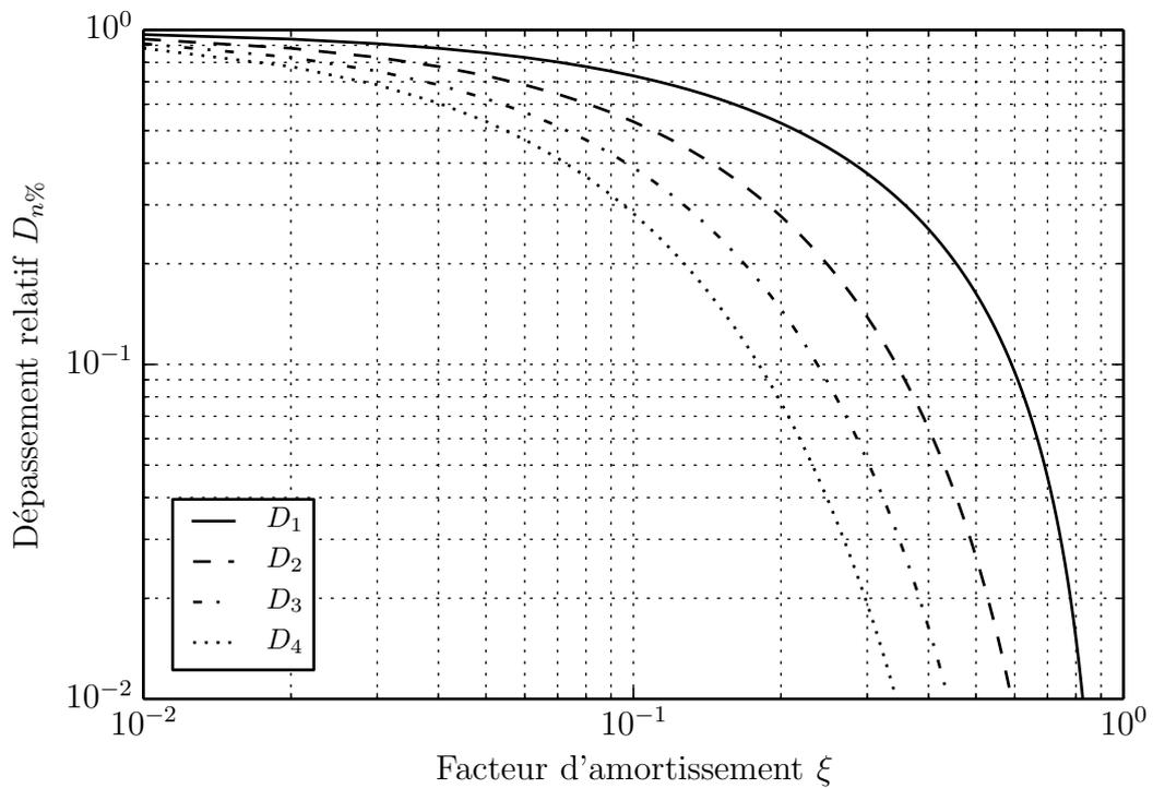
FIGURE 13 – Abaque des dépassements relatifs d'un système du second ordre.
