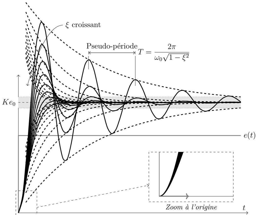
FIGURE 10 – Réponse indicielle d'un système du second ordre sous-amorti.
