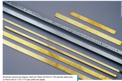
anciennes mesures de longueur, allant de l'étalon de Paris en 1554 (grande règle grise), au Pied du Roi en 1752-1774 (plus petite des règles).
