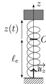
On suppose que la suspension décrite comporte un dispositif qui exerce sur le véhicule de masse  $m$ , une force d'amortissement visqueux donné par  $\vec{F} = -h\vec{v}$  où  $\vec{v}$  représente le vecteur vitesse verticale du véhicule par rapport à la route et  $h$  un coefficient appelé coefficient de frottement fluide.
