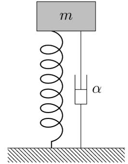
Q1. Déterminer la longueur du ressort à l'équilibre lorsque le moteur ne fonctionne pas.
