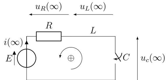
R23. Établir l'équation différentielle vérifiée par la tension aux bornes du condensateur  $u_c(t)$ , et l'écrire sous forme canonique
