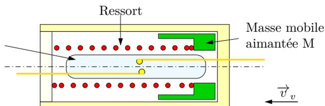
Le système est modélisé par une masse  $m$  retenue par un ressort de raideur  $k$  et de longueur à vide  $\ell_0$  et freinée par une force  $\vec{F} = -\alpha \vec{v}$ . On s'intéresse ici au mouvement de la masse lors d'une décélération  $a_0$  (en  $\text{m} \cdot \text{s}^{-2}$ ). On peut montrer que l'équation d'évolution de la position de la masse s'écrit comme :
