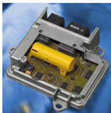
Ampoule de verre sous vide contenant deux lames métalliques qui se collent lorsqu'elles sont soumises au champ magnétique de la masse mobile  $M$ .
