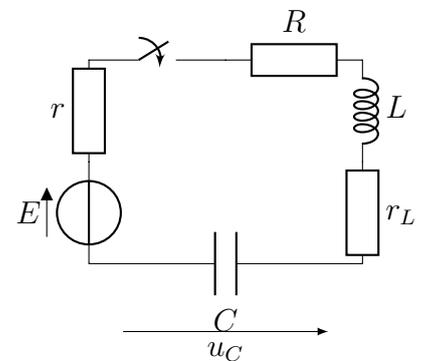
R20. Déterminer la résistance  $R_{\text{tot}}$  équivalente aux résistances de ce circuit. Reproduire le circuit avec  $R_{\text{tot}}$ .
