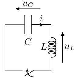
R11. Établir l'équation différentielle vérifiée par l'intensité du courant dans le circuit.
