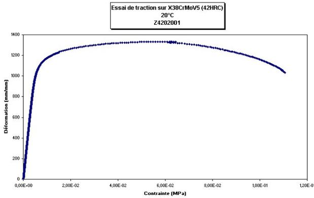
FIGURE 3 – Résultat d'un essai de traction sur un acier allié : courbe de la déformation  $\frac{\Delta l}{l_0}$  en fonction de la contrainte
