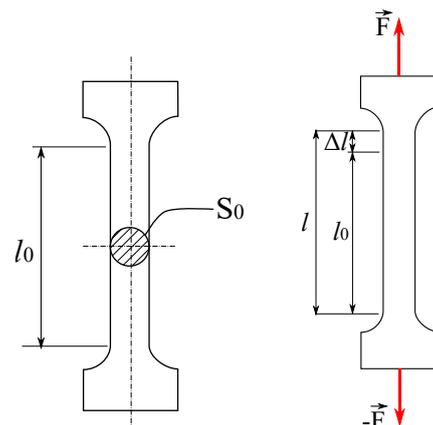
FIGURE 2 – Éprouvettes pour les tests de traction
