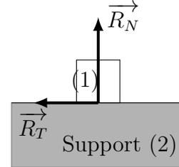
■ **S'il n'y a pas glissement** :  $\overrightarrow{v(1/\mathcal{R})} = \overrightarrow{v(2/\mathcal{R})} \Leftrightarrow \overrightarrow{v_g(1/2)} = \vec{0}$ , alors  $\|\overrightarrow{R_T}\| < f_s \|\overrightarrow{R_N}\|$ , avec  $f_s$  le **coefficient de frottement statique** [sans dimension, sans unité].
