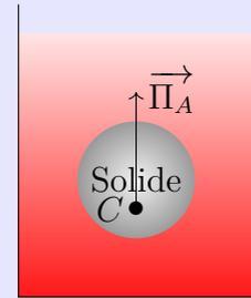
Ainsi la **poussée d'Archimède est opposée au poids du fluide déplacé** :  $\vec{\Pi}_A = -m_{\text{fluide déplacé}}\vec{g}$ . Dans le cas où le fluide est homogène (corps uniquement dans l'eau, ou dans l'air, et pas entre deux fluides), la poussée d'Archimède s'écrit :
