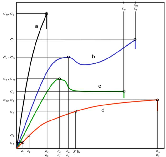
FIGURE 4 – Courbes générales de la contrainte en fonction de la déformation selon le matériau
