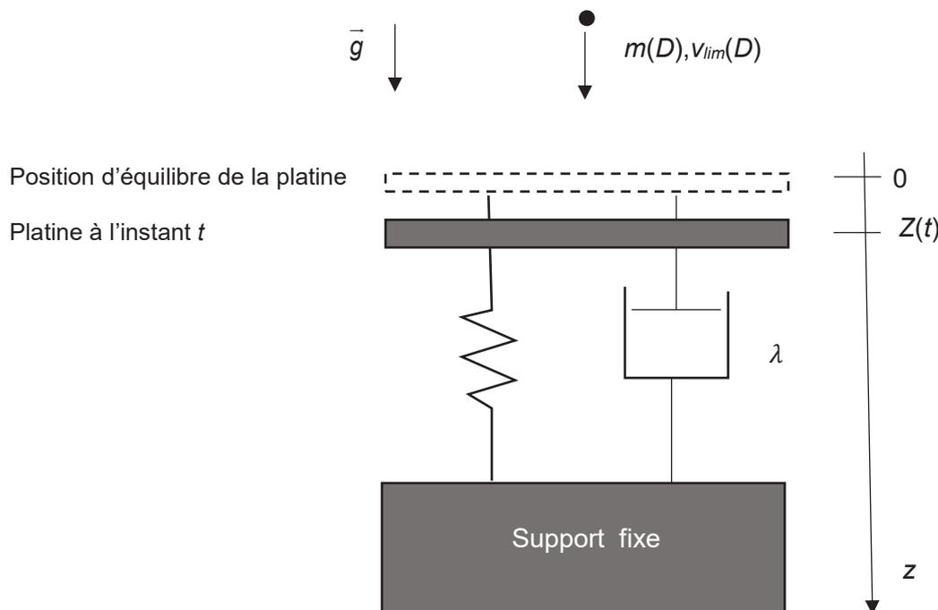
FIGURE 2 – Modélisation du disdromètre à impact à platine
