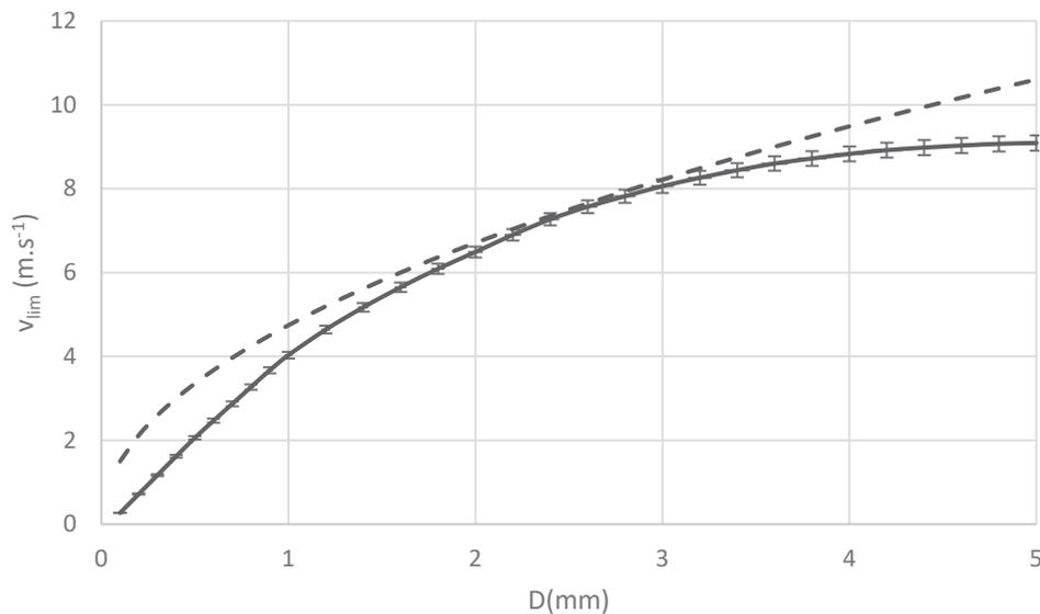
FIGURE 1 – Influence du diamètre sur la vitesse limite
