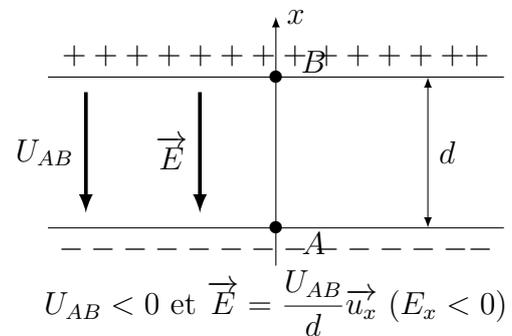
Q2. En utilisant un théorème énergétique, établir un lien entre la variation d'énergie cinétique  $\Delta \mathcal{E}_c = \mathcal{E}_c(B) - \mathcal{E}_c(A)$  et la différence de potentiel  $U_{AB} = V_A - V_B$ . À quelle condition la particule est-elle accélérée ?
