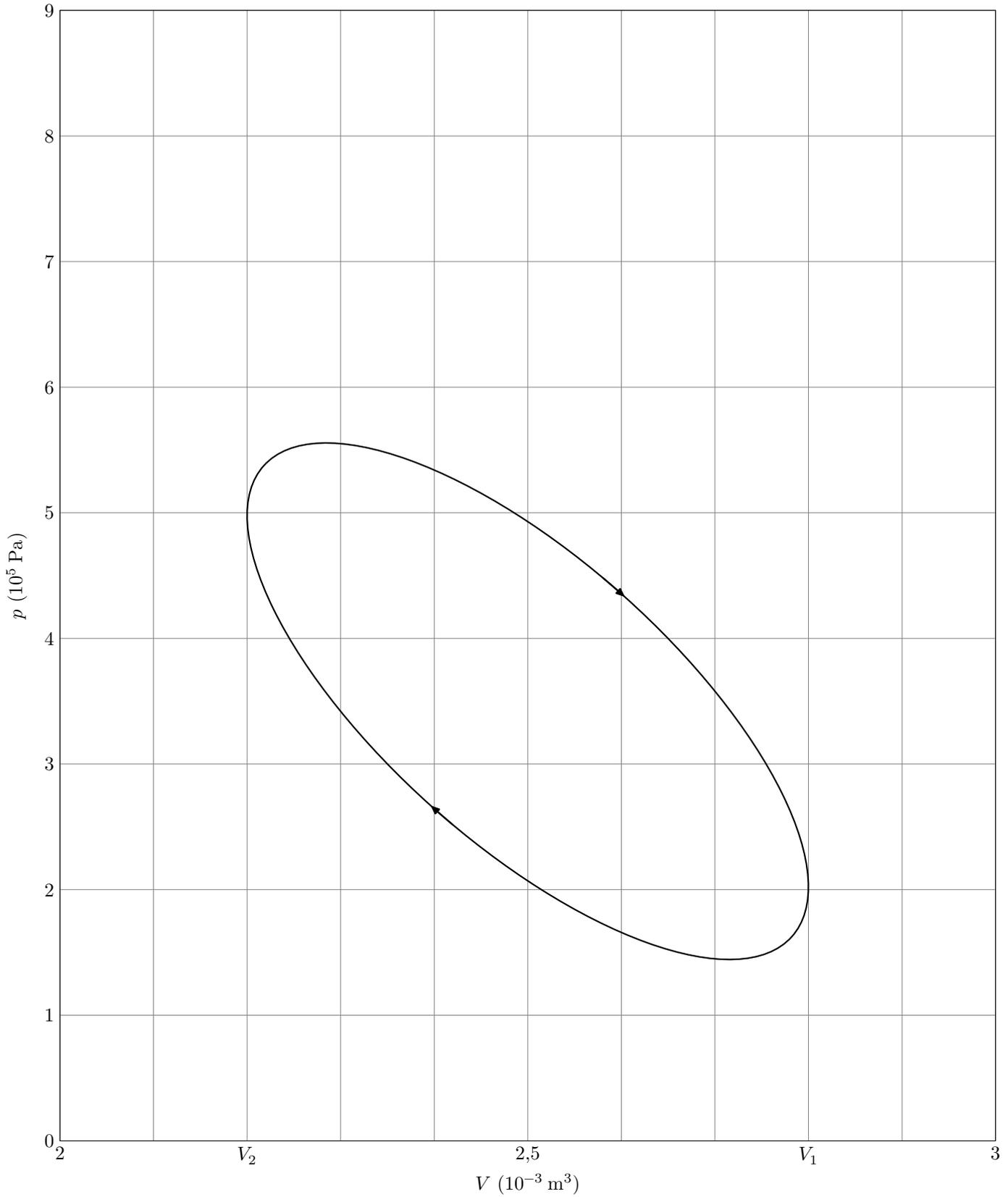
FIGURE 3 – Allure du cycle réel d'un moteur Stirling dans le diagramme  $(p, V)$
