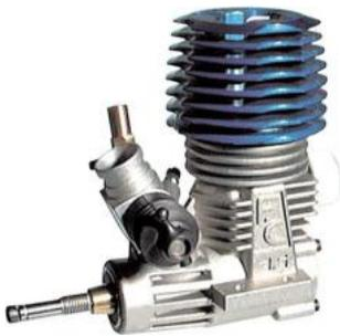
**Moteurs thermiques** (de voiture, centrale nucléaire, ...) : permet de convertir la chaleur récupérée par la combustion du carburant, en travail mécanique.
