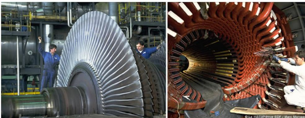
Un **alternateur** sert à convertir une puissance mécanique en une puissance électrique. Ce dispositif est par exemple utilisé
