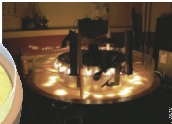
5. Dans ce dispositif de laboratoire monté par L. Quartier, une partie du sable disposé en anneau est poussée par une palette tournant autour du centre de l'anneau (le diamètre est de un mètre). Sur la palette sont tracés des arcs de cercle permettant de mesurer la quantité de sable poussé. La palette est aussi équipée d'un microphone qui enregistre les sons produits.
