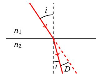
En optique, la loi de Descartes permet de déterminer la déviation d'un rayon lumineux, lorsque celui-ci traverse un dioptre qui sépare deux milieux transparents d'indices de réfraction différents. Dans le cas où un rayon passe d'un milieu d'indice  $n_1$  à un milieu d'indice  $n_2 > n_1$ , les directions du rayon incident et du rayon réfracté (mesurées par rapport à la normale au point d'incidence, voir le schéma), vérifient l'équation  $n_1 \sin i = n_2 \sin r$ .
