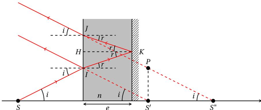
3. Pour déterminer la distance  $\overline{S'S''}$ , commençons par remarquer que  $S'P = IJ$  et que  $\tan i = \frac{S'P}{S'S''}$  (triangle  $S'S''P$ ).
