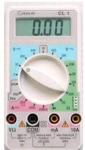
L'ampèremètre permet de mesurer l'intensité (algébrique) du courant qui circule dans une branche. Selon le sens dans lequel il est branché, il affichera une valeur positive ou négative. Pour le brancher dans un circuit, on utilise les bornes **A** et **COM** (pour des intensités importantes) ou bien les bornes **mA** et **COM** (pour des intensités plus faibles). On retient la convention suivante :
