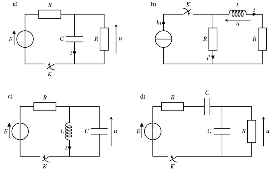
Calculer, dans chacun de ces circuits, les valeurs demandées à  $t = 0^+$ , date à laquelle on ferme l'interrupteur, le circuit étant complètement déchargé au préalable.
