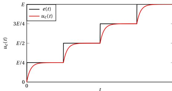
Un condensateur est chargé via un circuit  $RC$  série jusqu'à la tension  $E$  par paliers successifs, de valeurs  $\frac{E}{N}$ ,  $\frac{2E}{N}$ , ...,  $\frac{(N-1)E}{N}$  et  $E$ . On suppose que chaque palier est suffisamment long pour que la charge soit supposée complète.
