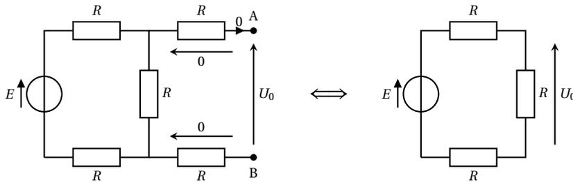
On calcule alors immédiatement la tension à vide avec la loi du pont diviseur de tension :  $U_0 = \frac{E}{3}$ .
