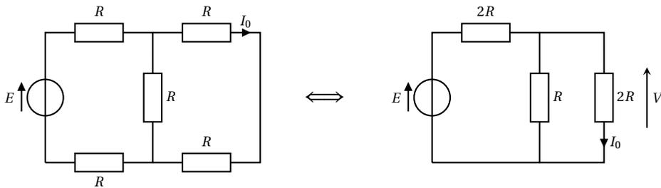
Avant de calculer l'intensité  $I_0$  on va chercher à exprimer la tension  $V$  aux bornes des deux résistors en dérivation. Pour cela on rassemble ces deux résistances en une résistance équivalente telle que :
