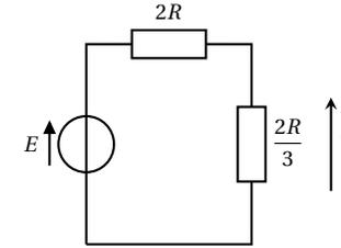
On calcule  $V$  à l'aide de la loi du pont diviseur de tension :
