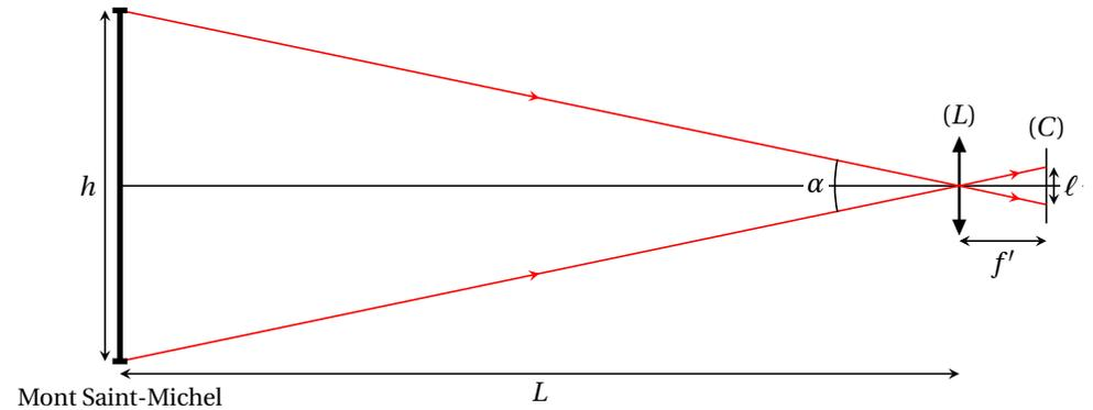
On détermine  $\ell$  en mesurant sur la photographie la distance qui sépare le niveau de la baie de la pointe de la flèche et en la rapportant à l'échelle du capteur. On trouve que l'image du Mont a une taille égale à 35% de la hauteur du capteur. On en déduit que :
