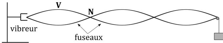
Les vibrations de la corde sont quasi-nulles, sauf lorsque la fréquence est celle d'un mode propre. On voit alors apparaître des fuseaux, caractéristiques de l'apparition d'une onde stationnaire dans le système. Plus la fréquence augmente et plus le nombre de fuseaux augmente (normal car  $\lambda$  diminue lorsque  $f$  augmente).
