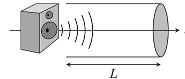
Un haut-parleur est placé à l'entrée d'un tube (voir figure ci-dessus). Il est alimenté par une tension sinusoïdale de pulsation  $\omega$ . La célérité des ondes sonores dans l'air est notée  $c$ . Une surface réfléchissante placée en bout de cuve en  $z = L$  engendre une onde réfléchie.
