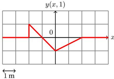
Une onde progressive, caractérisée par la fonction  $y(x, t) = f(x - ct)$  se propage le long d'un axe  $Ox$  avec une célérité  $c = 2 \text{ m} \cdot \text{s}^{-1}$ . On représente l'allure de cette onde à la date  $t = 1 \text{ s}$  sur le schéma ci-contre.
