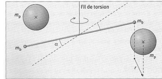
En 1798, H. Cavendish utilise un pendule de torsion pour mesurer la masse de la Terre et déterminer sa densité. Ses mesures permettent de déterminer la valeur de la constante de gravitation universelle  $G$  (qui n'avait pas encore été définie à l'époque).
