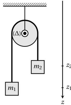
On abandonne, à  $t = 0$ , les deux masses depuis la position  $z_1(0) = z_2(0) = 0$  sans vitesse initiale. On suppose que le contact entre le fil et la poulie s'effectue sans glissement. On admet alors que pour le système {masses + fil + poulie}, la puissance des forces intérieures est nulle.
