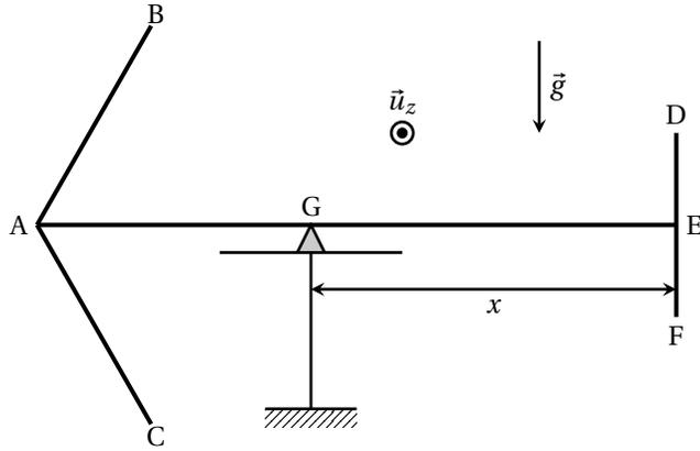
On modélise une ancre par un solide constitué de quatre portions rectilignes : AB, AC, AE et DE. Les portions AB et AC forment chacune un angle de  $60^\circ$  avec la portion AE. On suppose que la masse totale, notée  $m$ , est répartie de manière homogène. On pose  $AB = AC = DF = L$  et  $AE = 3L$ .
