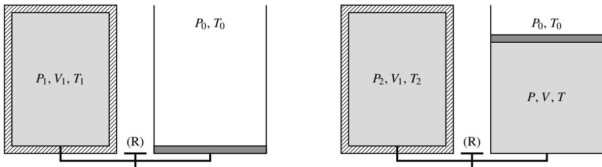
FIGURE 1 : Bouteille sous pression raccordée à une enceinte, avant ouverture du robinet (R) (à gauche) et après ouverture (à droite)
