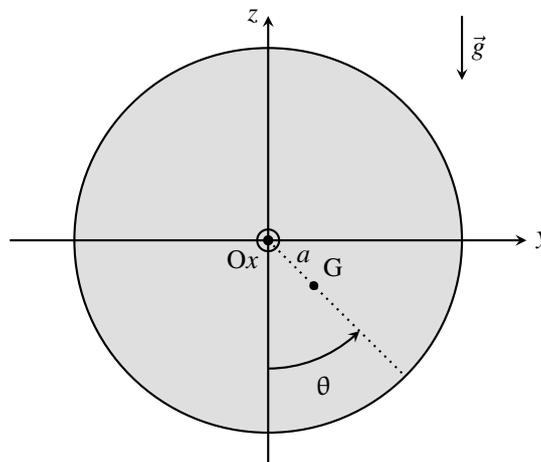
FIGURE 1 : Déséquilibre d'une machine tournante
