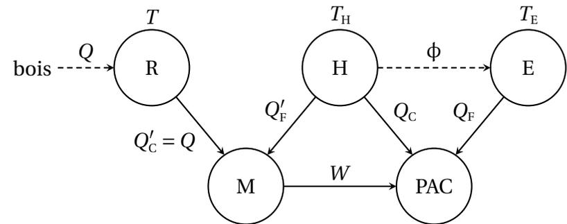
On note  $Q$  le transfert thermique fourni par le bois et transmis au moteur par l'intermédiaire du réservoir. Sur la figure,  $Q'_C$  et  $Q'_F$  sont positifs quand le moteur reçoit de l'énergie.  $W$ ,  $Q_C$  et  $Q_F$  sont positifs quand la PAC reçoit de l'énergie.
