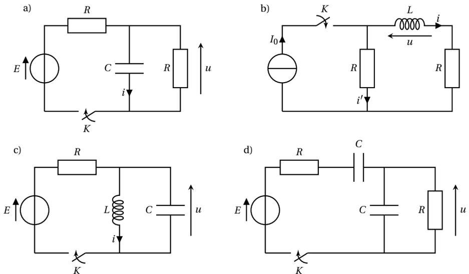
Calculer dans chacun de ces circuits les valeurs demandées à  $t = 0^+$ , date à laquelle on ferme l'interrupteur, le circuit étant complètement déchargé au préalable.
