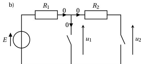
D'après la loi des nœuds, le courant qui circule dans  $R_1$  est nul. Les tensions aux bornes des deux résistances sont nulles donc  $u_1 = u_2 = E$ .
