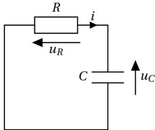
Par continuité, la tension aux bornes du condensateur, à l'instant du branchement, vaut  $u(0^+) = u_0$ .
