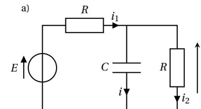
Par continuité de la tension aux bornes du condensateur,  $u(0^+) = u(0^-) = 0$ . On en déduit que  $i_2(0^+) = 0$  (loi d'Ohm) et que  $i_1(0^+) = i(0^+)$  (loi des nœuds).
