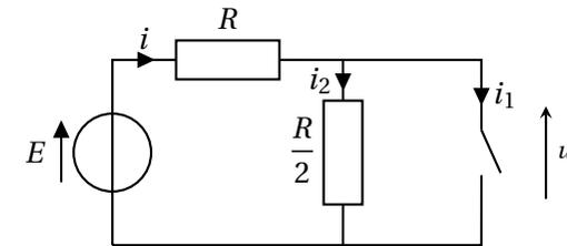
1. À  $t = 0^-$ , le condensateur est chargé et se comporte comme un interrupteur ouvert, donc  $i_1(0^-) = 0$ . On écrit ensuite  $i(0^-) = i_2(0^-)$  (loi des nœuds) puis  $u(0^-) = \frac{R/2}{R+R/2} E = \frac{E}{3}$  (loi du pont diviseur de tension, valable ici car  $R$  et  $R/2$  sont parcourues par le même courant à  $t = 0^-$ ).
