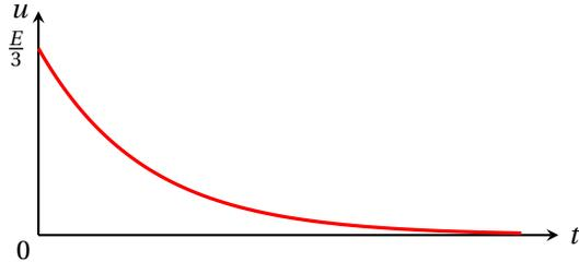
6. Au cours de la décharge, le condensateur cède à la résistance une énergie  $\mathcal{E} = \frac{1}{2} C u^2(0^+) = \frac{CE^2}{18}$ .
