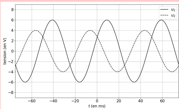
Le graphique ci-dessus représente l'évolution temporelle de deux tensions alternatives. Déterminer l'amplitude et la fréquence de chaque signal puis le déphasage entre les deux. Lequel est en avance sur l'autre ?
