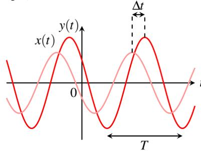
On dit que  $y(t)$  est en avance sur  $x(t)$  si, sur l'intervalle  $\Delta t$ , le maximum de  $y(t)$  précède celui de  $x(t)$ . Inversement on dit que  $y(t)$  est en retard sur  $x(t)$  si, sur l'intervalle  $\Delta t$ , le maximum de  $x(t)$  précède celui de  $y(t)$ .
