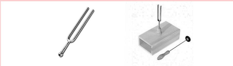
**Figure 1** – Gauche : diapason de musicien. Droite : diapason (avec son marteau) muni d'une caisse de résonance pour améliorer l'émission sonore, utilisé dans l'enseignement
