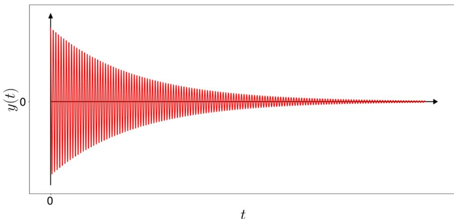
On retient que dans ce domaine le système oscille quasiment à la pulsation propre :  $\omega \simeq \omega_0$ ,
