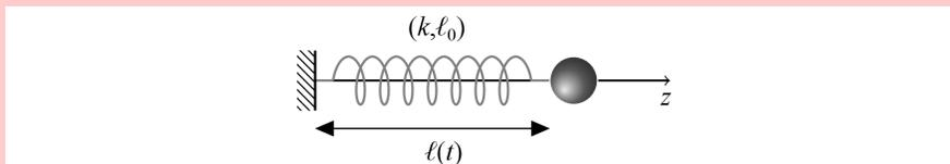
**Figure 2** – Modélisation des branches du diapason par un oscillateur masse-ressort horizontal. La coordonnée  $z$  repère la position de la masselotte sur l'horizontale
