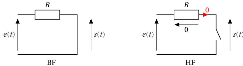
En BF la sortie est branchée aux bornes d'un court-circuit :  $s = 0$ .
