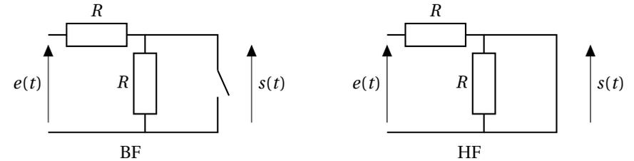
En BF on peut supprimer la branche ouverte. La sortie est branchée aux bornes de la résistance "verticale". On détermine la tension de sortie à l'aide de la loi du pont diviseur de tension :  $s = e/2$ .
