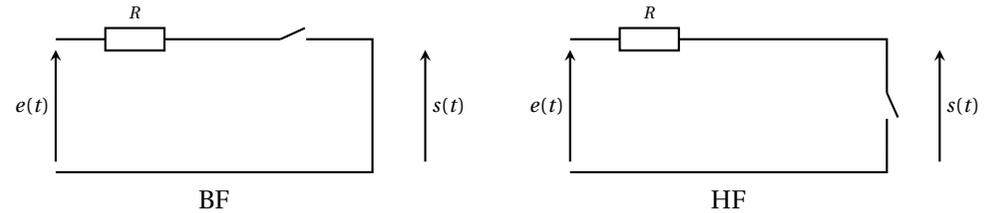
En BF,  $s = 0$  (tension aux bornes d'un fil). En HF,  $s = e$  (la tension aux bornes de la résistance est nulle car  $i = 0$ ).
