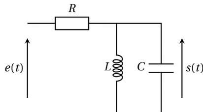
On vérifie avec des schémas équivalents en BF et HF qu'il est bien passe-bande.
