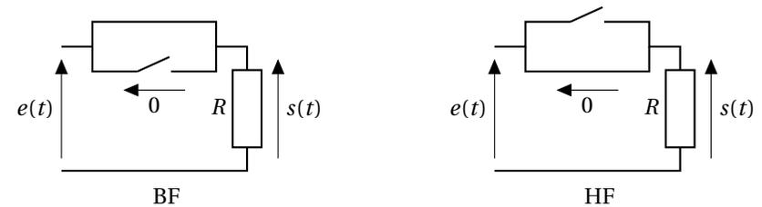
En BF comme en HF, la tension aux bornes des deux dipôles en dérivation est nulle car l'un des deux se comporte comme un court-circuit. D'après la loi des mailles :  $s = e$ .
