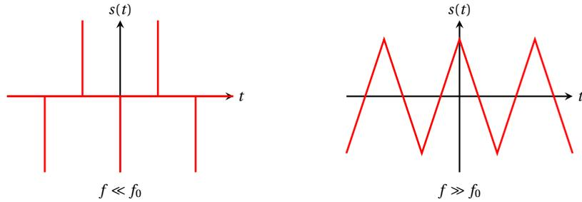
3. Le même raisonnement pour un signal d'entrée triangulaire conduit à dire que la sortie de sortie a la forme :
