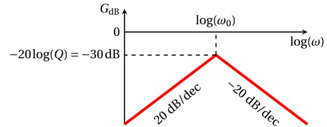
2. On trace l'allure du spectre en amplitude du signal d'entrée et on indique la bande passante.
