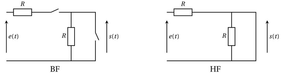
En BF,  $s = 0$  (le courant est nul dans la résistance "verticale"). En HF,  $s = 0$  (tension aux bornes d'un fil). Par conséquent, le filtre est un passe-bande.
