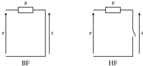
En BF,  $s = 0$  (tension aux bornes d'un fil). En HF,  $s = e$  (loi des mailles) car la tension aux bornes de  $R$  est nulle. Par conséquent, le filtre est un passe-haut.
