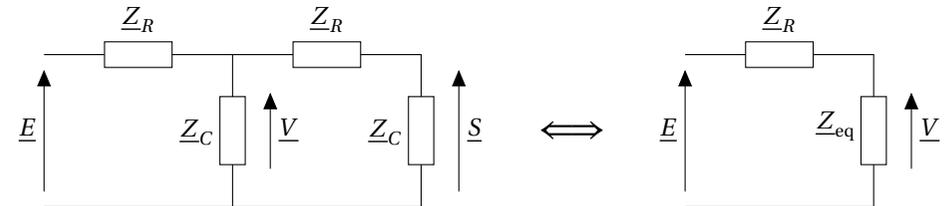
L'admittance équivalente vaut :  $\underline{Y}_{\text{eq}} = \frac{1}{Z_C} + \frac{1}{Z_C + Z_R} = jC\omega \frac{2 + jRC\omega}{1 + jRC\omega}$ . On calcule  $V$  :
