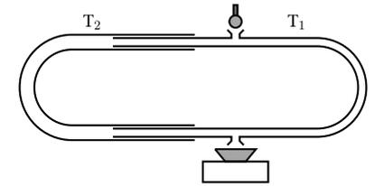
En déplaçant la partie mobile  $T_2$  on fait varier l'amplitude du signal observé. Elle passe deux fois de suite par une valeur minimale lorsqu'on déplace  $T_2$  de  $d = 11,5$  cm.
