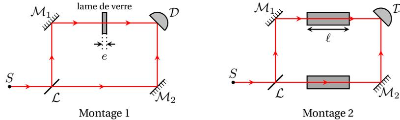
Dans un premier temps, on place une lame de verre d'indice de réfraction  $n$  et d'épaisseur  $e$  sur l'un des deux chemins (**montage 1**).
