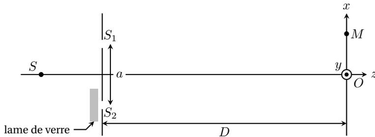
On étudie le dispositif des trous d'Young. Deux trous, séparés s'une distance  $a = 0,10$  mm, sont éclairés par une lumière de longueur d'onde dans le vide  $\lambda = 450$  nm. Un écran est situé à une distance  $D = 20$  cm, où l'on étudie l'intensité lumineuse au point  $M(x, y)$ . L'ensemble est dans l'air, assimilé au vide. La figure ci-dessus illustre la situation. Initialement la lame de verre est absente.
