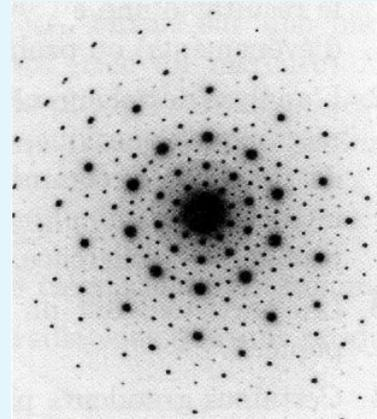
Figure de diffraction d'électrons à travers un cristal fait d'un alliage Al Mn Si
