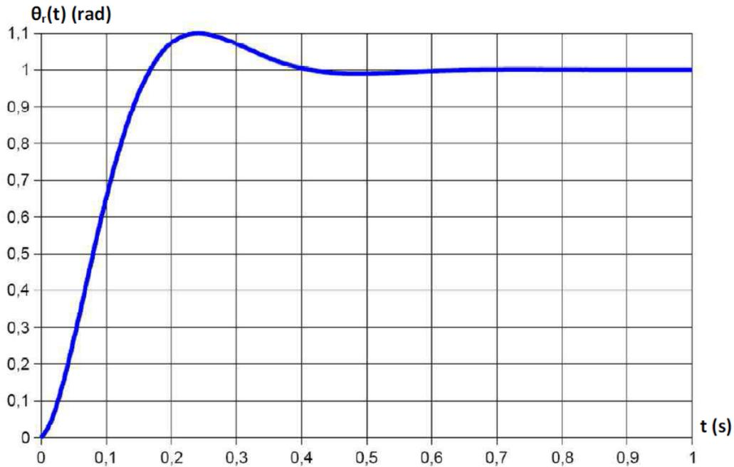
**Question 5:** Déterminer la fonction de transfert de  $H(p) = \frac{\theta_r(p)}{\theta_c(p)}$ . Montrer que cette fonction peut se mettre sous la forme  $H(p) = \frac{K}{1 + \frac{2\xi}{\omega_0}p + \frac{p^2}{\omega_0^2}}$ . Déterminer les expressions de  $K$ ,  $\xi$  et  $\omega_0$  en fonction de  $K_m$ ,  $\tau$ ,  $A$  et  $B$ .
