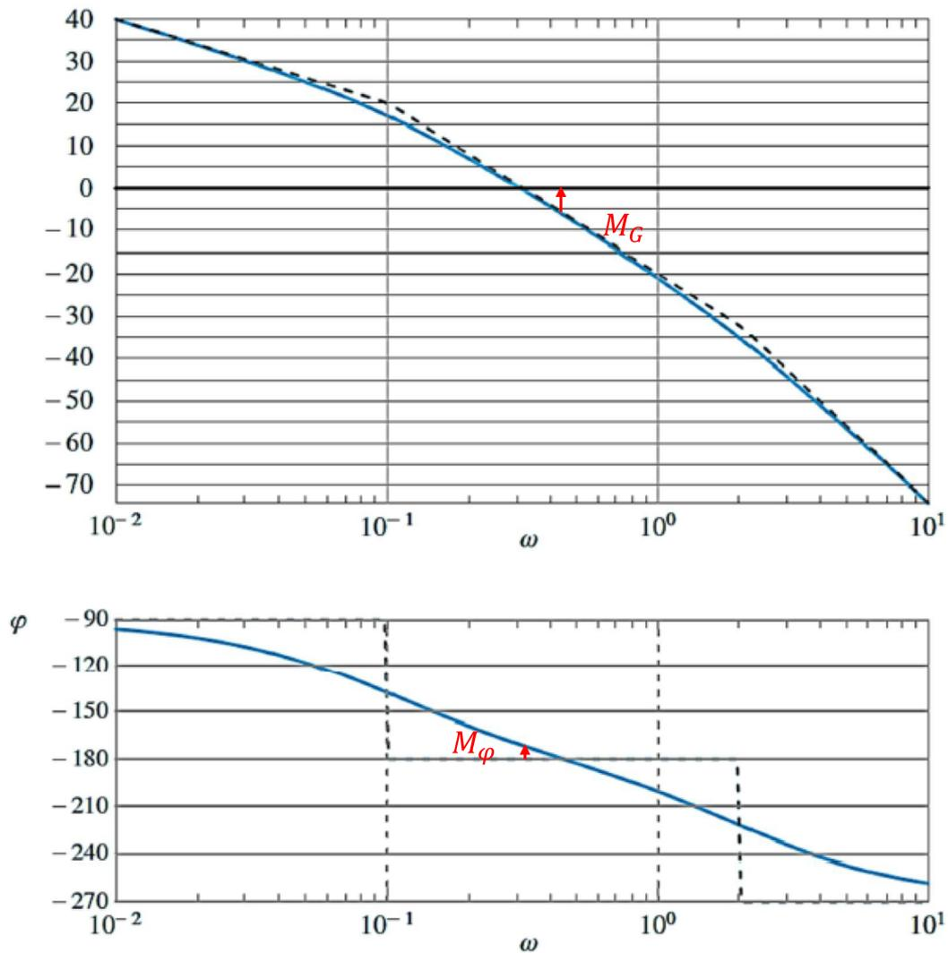
**Question 2:** En traçant sur le diagramme, déterminer les valeurs des marges de phase et de gain. En déduire que le système est stable.
