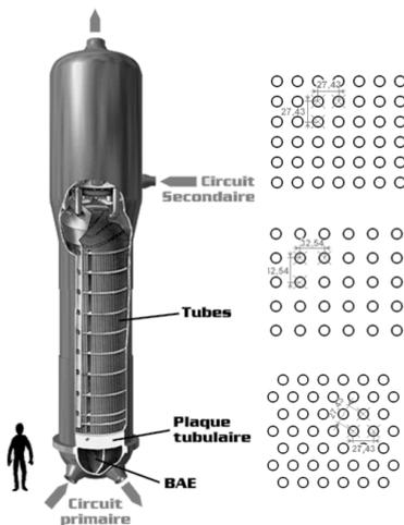
Le robot positionneur TRIBAR permet de contrôler les tubes des générateurs de vapeur d'une centrale nucléaire. Pour cela, le robot doit :
