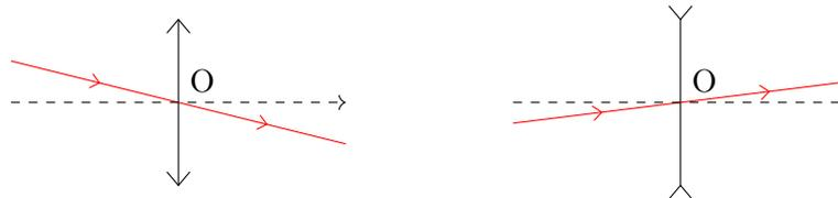
**Fig. 4** – Les rayons passant par le centre O d'une lentille ne sont pas déviés.
