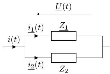
**Fig. 1** – Le pont diviseur de courant.
