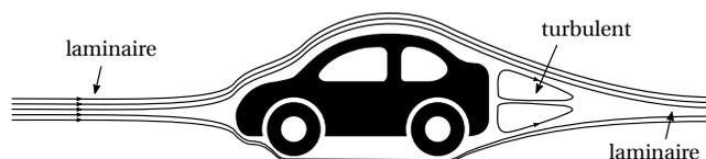
▲ **Figure C1.** Nature de l'écoulement autour du véhicule.
