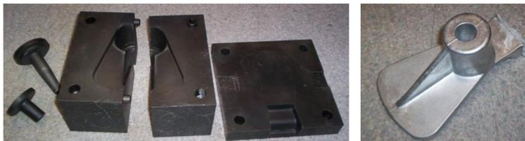
Pièce obtenue par moulage (à droite) et les moules utilisés (à gauche)
