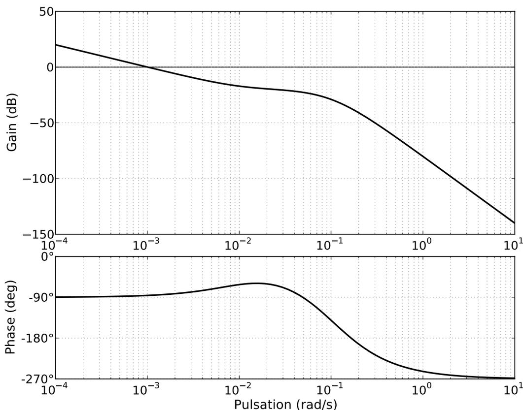
Q° - Déterminer les valeurs de  $K_i$  qui permettent de respecter les marges de stabilité :  $M_\phi > 45^\circ$  et  $M_G > 15 \text{ dB}$ .
