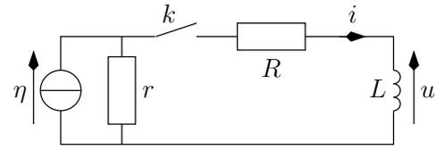
1. Déterminer l'intensité  $i(t)$  qui traverse la bobine pour  $t \geq 0$ .
