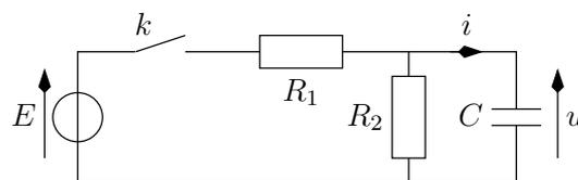
1. Établir l'équation différentielle satisfaite par la tension  $u(t)$  aux bornes du condensateur.
